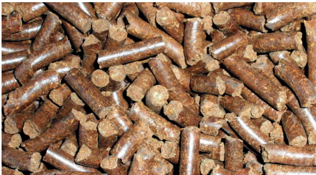
Pellety – surowiec energetyczny w postaci sprasowanych trocin i pyłu drzewnego ( www.makepellets.com )
